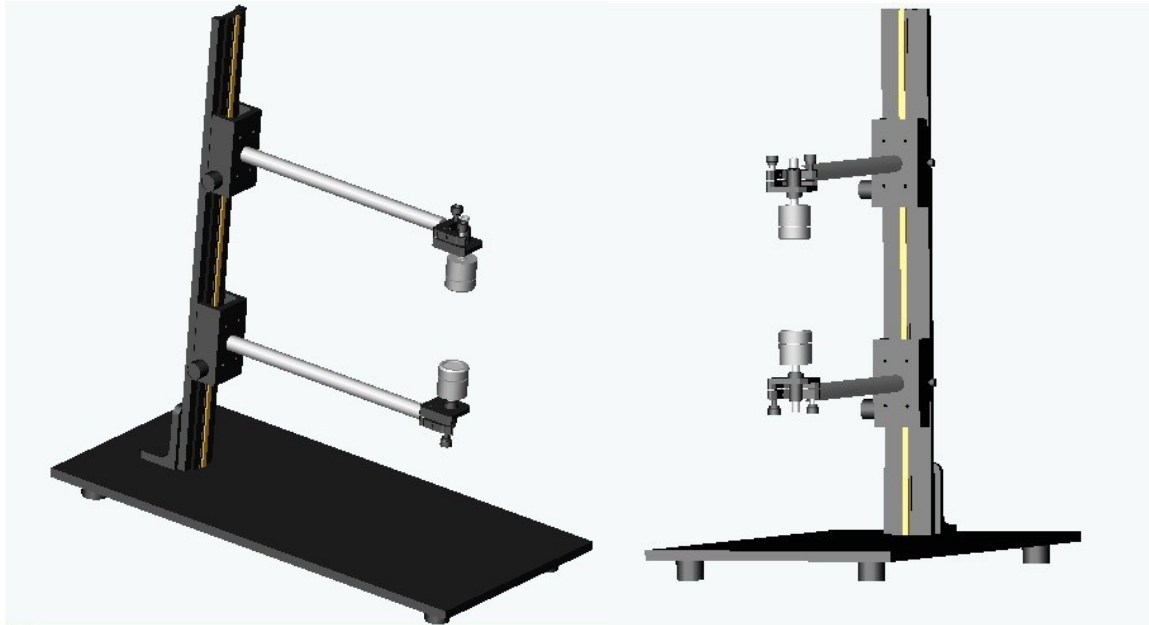
Rys. 4.2.1. Stanowisko ultradźwiękowe do badań bezkontaktowych iPass
